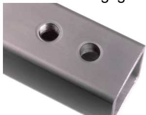
Flowdrill® 7,4 Short/Flat (M8), rejftet glat med emnets overside.
